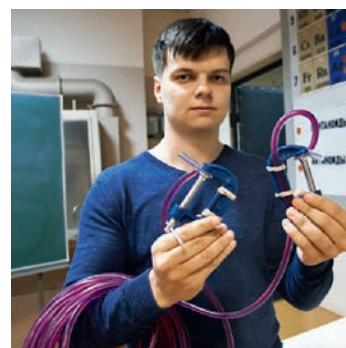
Рис. 3. Трубка заполнена подкрашенной водой, концы зажаты струбцинами
